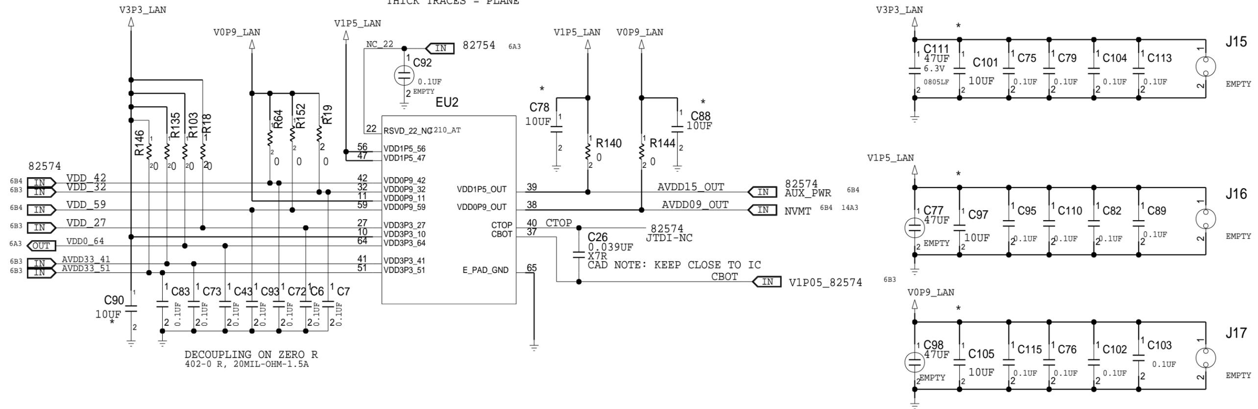
\*LOCALIZED AND DISTRIBUTED BULK CAPACITANCE RANGE ~15UF
