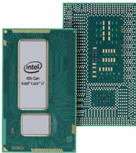
图 4. 第 4 代小外形英特尔® 酷睿™ 处理器将 CPU 和芯片组集成至一个封装内
