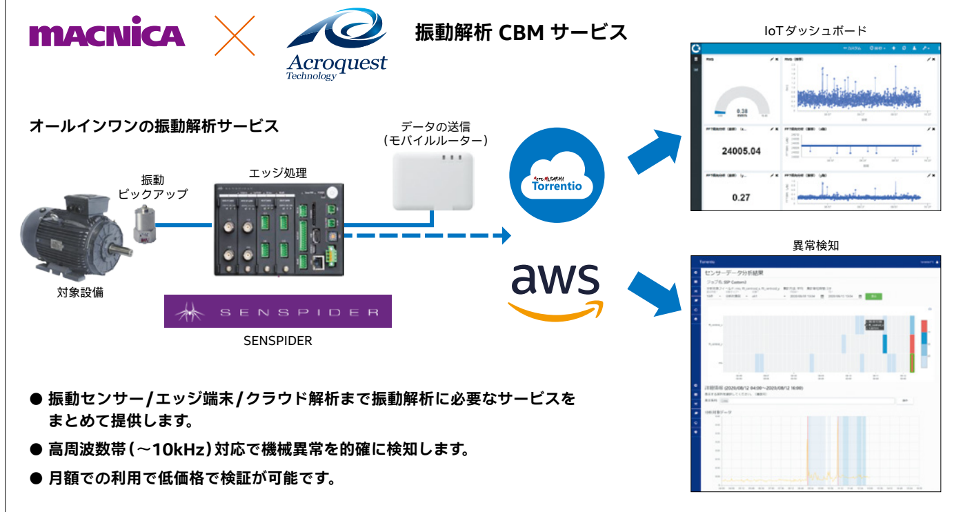
図 1. マクニカのエッジ・コンピューティング端末「SENSPIDER」と、アクロクエストテクノロジーの IoT データ分析プラットフォーム「Torrentio Cloud」とを組み合わせた、「振動解析 CBM サービス」の概略構成
