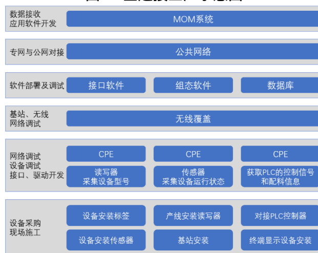
图18 全连接工厂数据采集方案图
