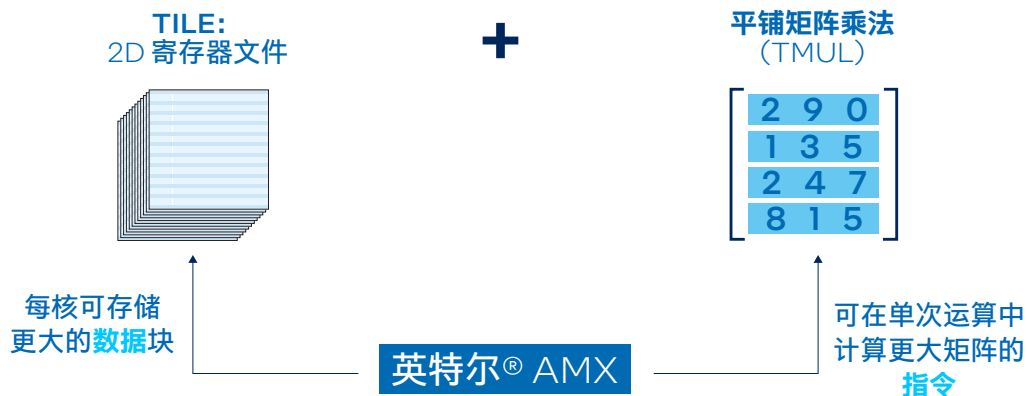
图 6. 英特尔® AMX 架构由 2D 寄存器文件 (TILE) 和 TMUL 组成
