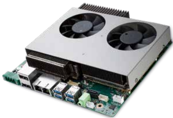
图 1: 研华 AIMB-288E 搭载第 13 代英特尔® 酷睿™ 处理器，采用超薄专用散热器。
