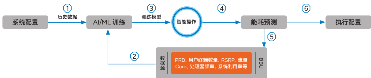
图 3 亚信科技基站智能节能方案基本工作流程
