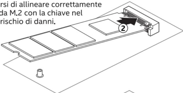
Spingere la scheda M.2 verso il basso e inserire la vite nel distanziatore per fissare.
