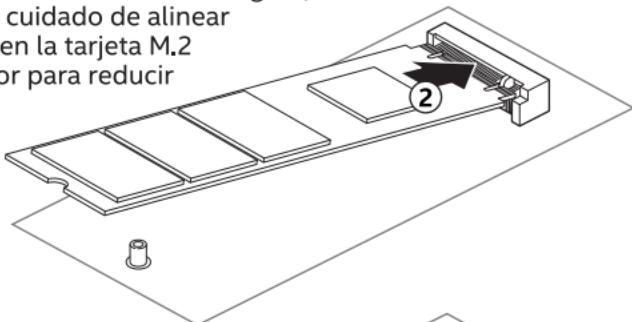
Empuje la tarjeta M.2 hacia abajo y vuelva a colocar el tornillo en su lugar para sujetar.
