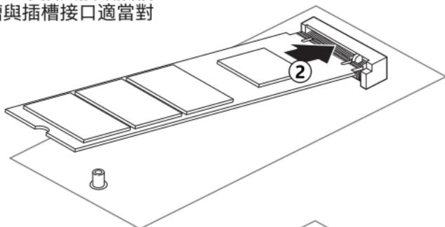
將 M.2 卡向下壓並重新鎖緊螺絲
