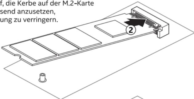
Drücken Sie die M.2-Karte nach unten und setzen Sie die Schraube erneut in den Abstandshalter ein, um die Karte zu sichern.
