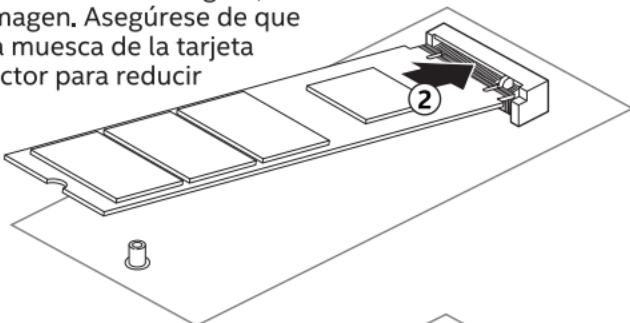
Empuje hacia abajo la tarjeta M.2 y vuelva a colocar el tornillo en su soporte para asegurarla.
