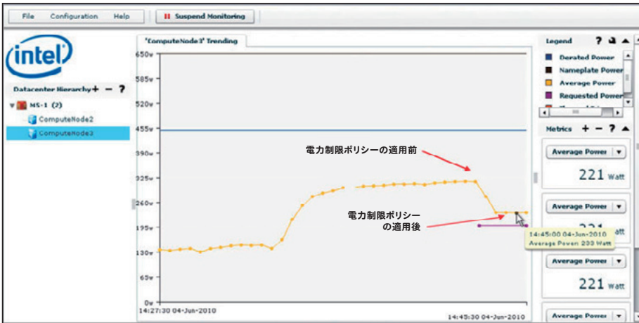
図 20 : 電力消費量の監視
