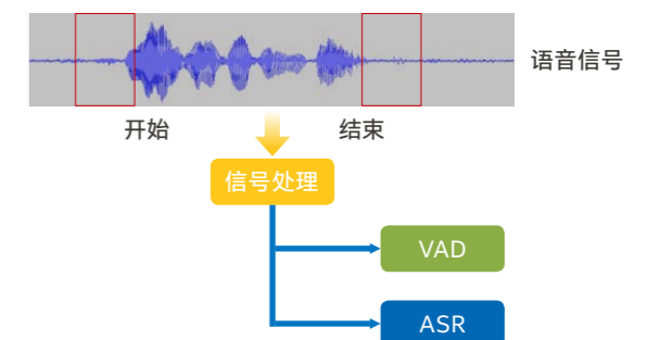
图 2-4-10 VAD 与 ASR 并行化设计的实时在线语音识别架构
